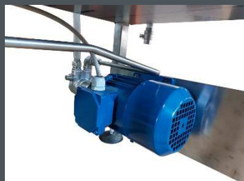
Pompa di alimentazione
